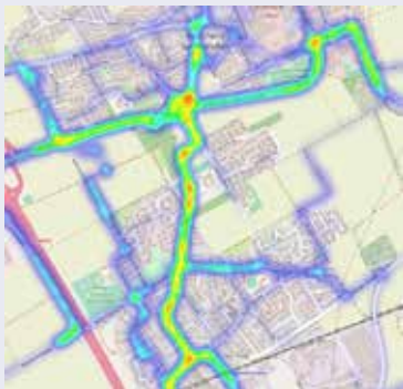
Verschiedenste Technologien sind bereits heute im Einsatz – beispielsweise erfassen Verkehrssensoren das Fahrzeugaufkommen im Ort
