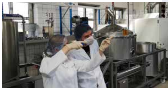
Begutachtung der Trübung des Biersuds während des Brauprozesses im Technikum des Instituts für Lebensmitteltechnologie | Bild: HSWT
